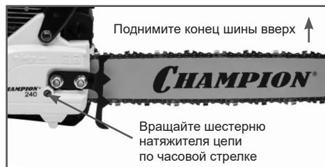
Рис. 5 Регулировка натяжения цепи
