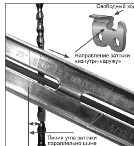
Рис. 28 Определение угла заточки
