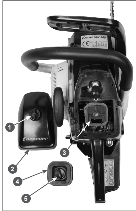
Рис. 20 Обслуживание воздушного фильтра
