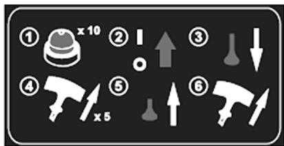
Рис. 10 Алгоритм запуска двигателя
