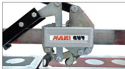
Механизм каретки состоит из 13 скрытых шарикоподшипников.
