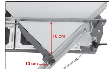
**Рез.** Опустите режущий ролик на керамическую плитку и плавно произведите рез.
