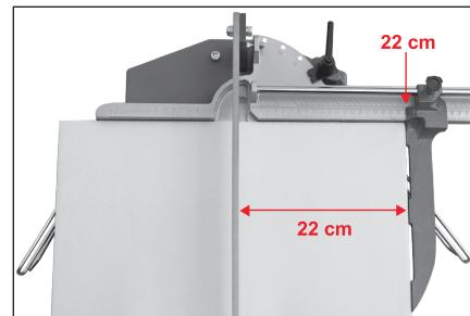
**Регулировка на 45°.** Установите линейку в положение 45° и зафиксируйте ее. Отрегулируйте размер, который вы хотите резать с помощью упора на линейке и считывайте размер по верхней шкале.
