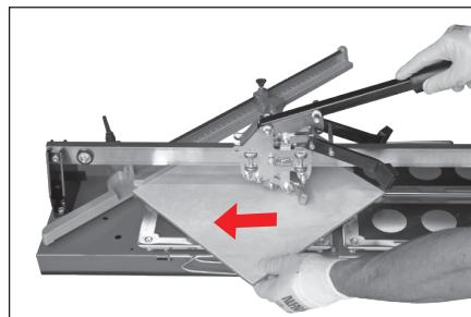
**Разлом.** Слегка нажмите на рычаг вниз для разлома плитки.
