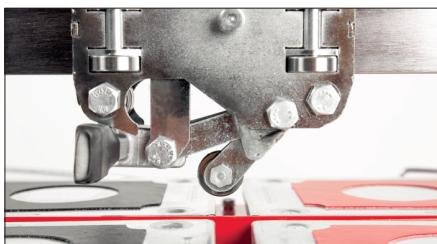
Режущий ролик Ø 22 мм.
